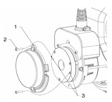
Figure 4-6. Manual Disengage
